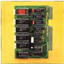
Foto di un'unità di base scheda grafica Basic
